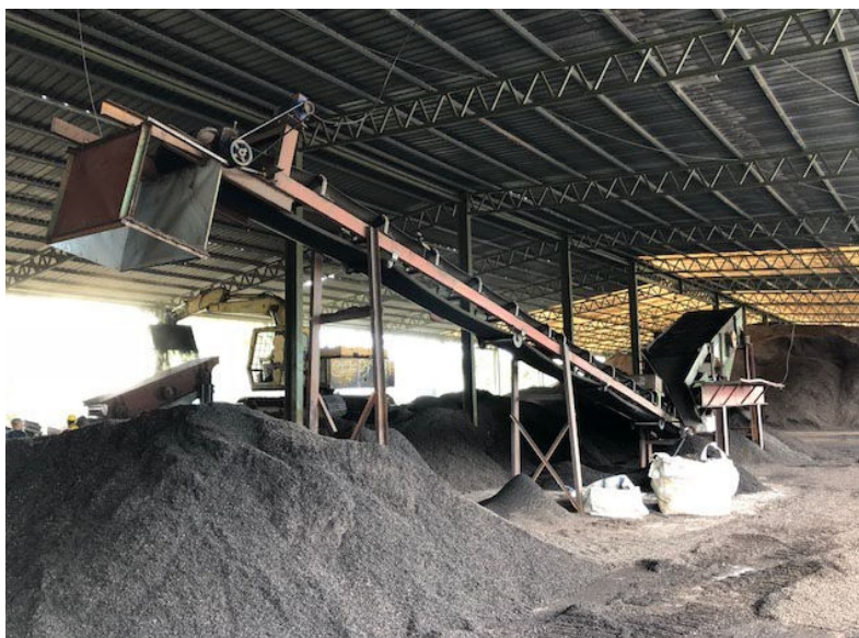
設備の整った屋根付きストックパイルでPKSの燃料品質を高める
